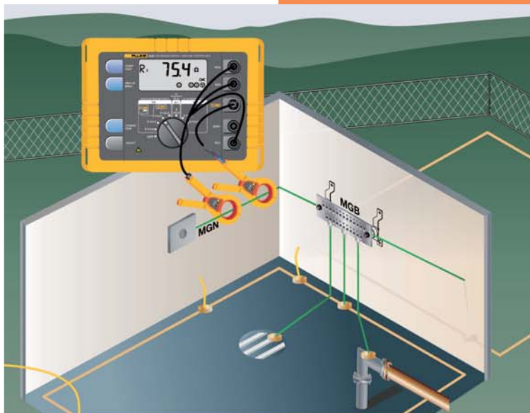
图 1：中心局的无辅助极测试法
