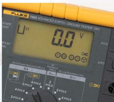
利用 Fluke 1625 检查您的接地系统是否良好
