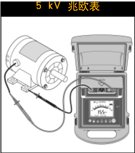
图2-5. 5 kV 的兆欧表被用于预防性维护程序，检查马达绕组的完整性和故障率。
