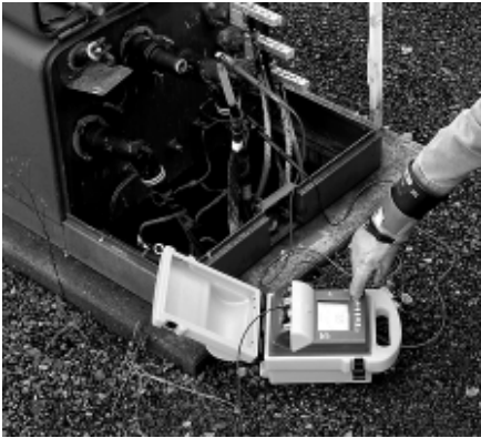
利用兆欧表对设备绝缘进行预防性维护测试。
