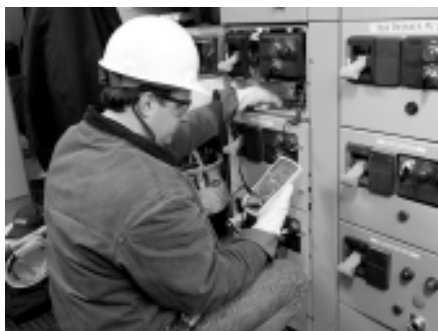
图4-5. 在收集到关键信息之后，对设备进行一系列的绝缘电阻测试。
