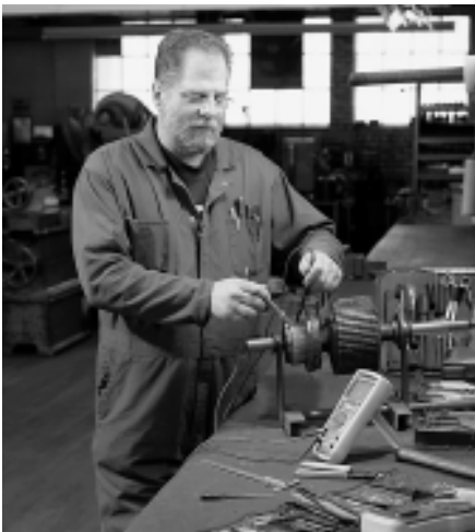
绝缘多用表可用来在重新缠绕导线之前检查导线段之间的绝缘完整性。
