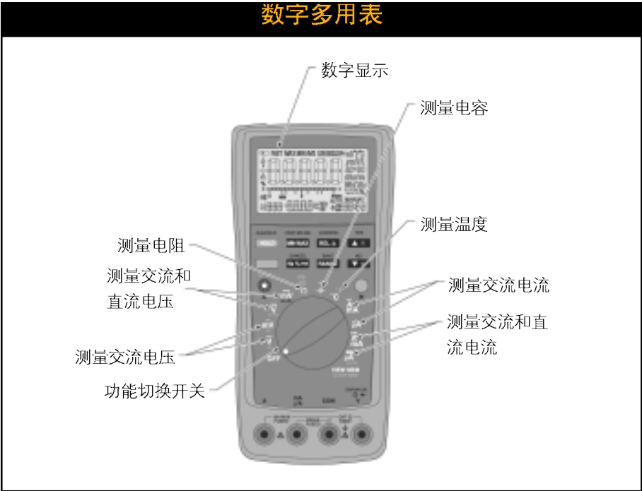
图2-2. 数字多用表可以测量电压、电流、电容、温度和电阻。
