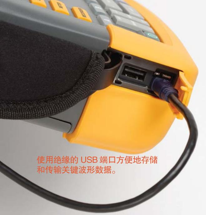
使用绝缘的 USB 端口方便地存储和传输关键波形数据。
