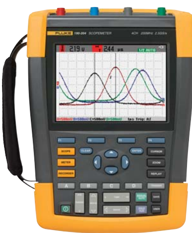
四通道 Fluke 190 II 系列 ScopeMeter 的带宽高达 200 MHz,实时采样率高达 2.5 GS/s。
