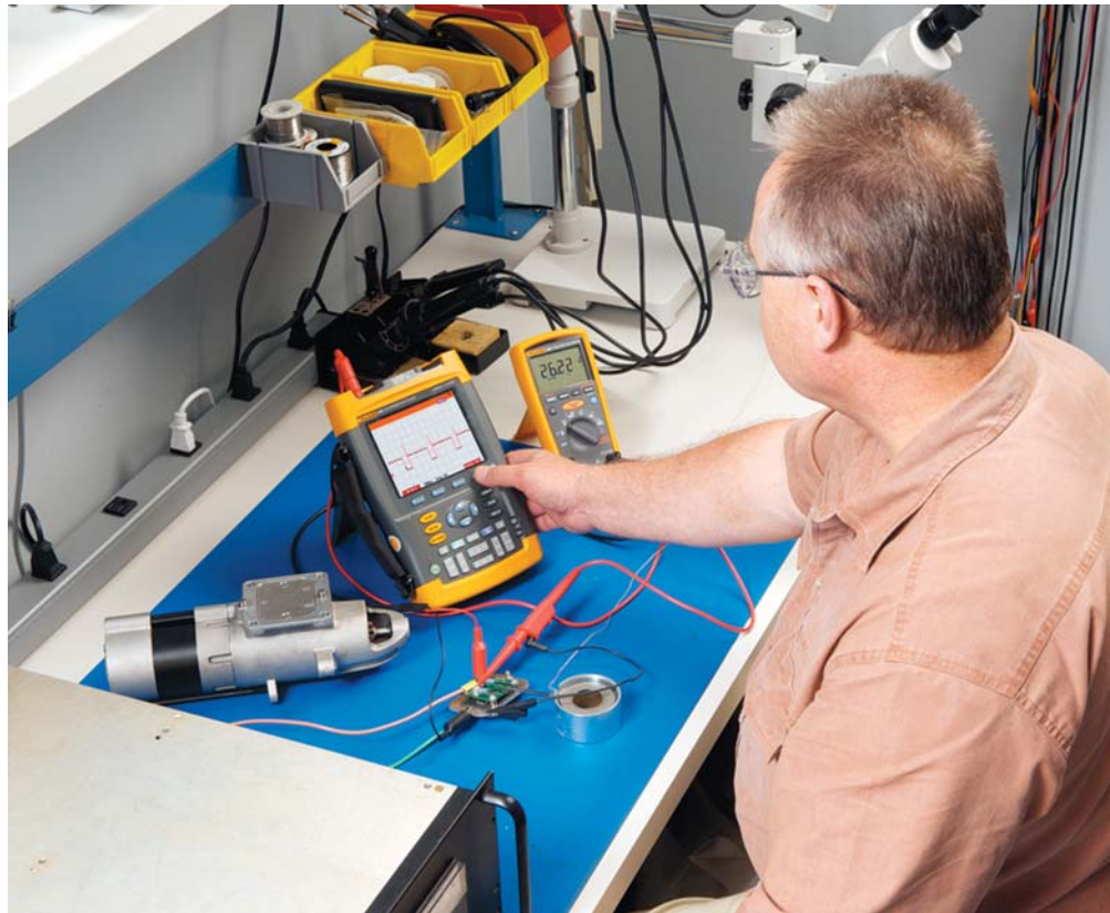
通过调整 ScopeMeter® 测试工具的触发电平，技术人员可进一步隔离尖峰根源。
