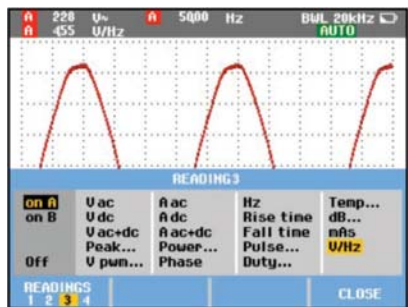
图3.选择 V/Hz 比，测量输入 A。
