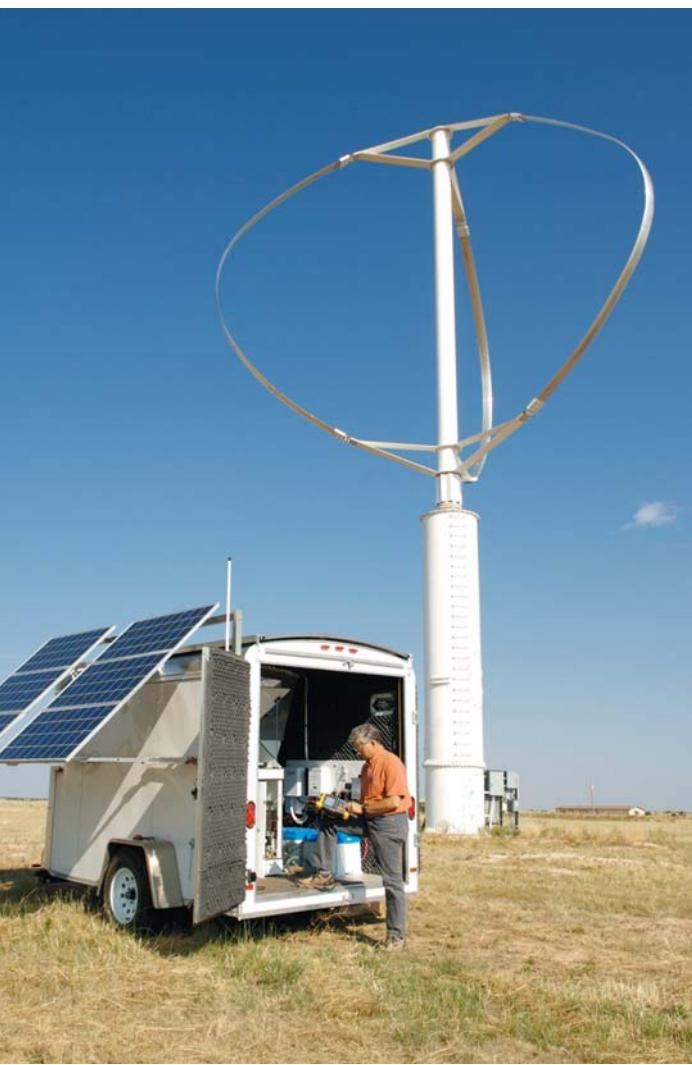
Powell的努力涉及到一种称为“Atmospheric Research and Technology (ART) Model VT 1 SODAR (Sonic Detection And Ranging)”的小型、自给系统移动单元的帮助。SODAR是一种自给系统、电池供电的移动实验室，包括48个用于声波传输的集成扬声器，精密的电子器件和模型化软件，用于分析风速和方向。“我们没有市电，也没有有线通信，例如电话线。”他介绍说：“但是在新墨西哥州，我们几乎能穿越到任何地方。我们有无处不在的太阳提供动力，在条件稍好时，我们还有无线通信。”他说，团队利用无线系统验证SODAR的工作是否符合其技术指标参数，如果需要的话，还能为客户提供实时数据。
