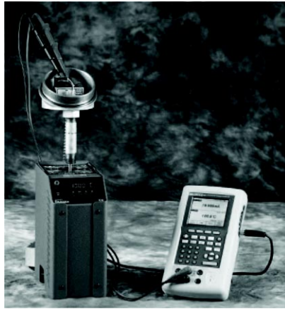
图 5. Fluke 744 和 Hart Scientific 校准 4-20mA 变送器和温度传感器
