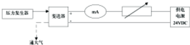
图2 二线制电动变送器检定原理框图
